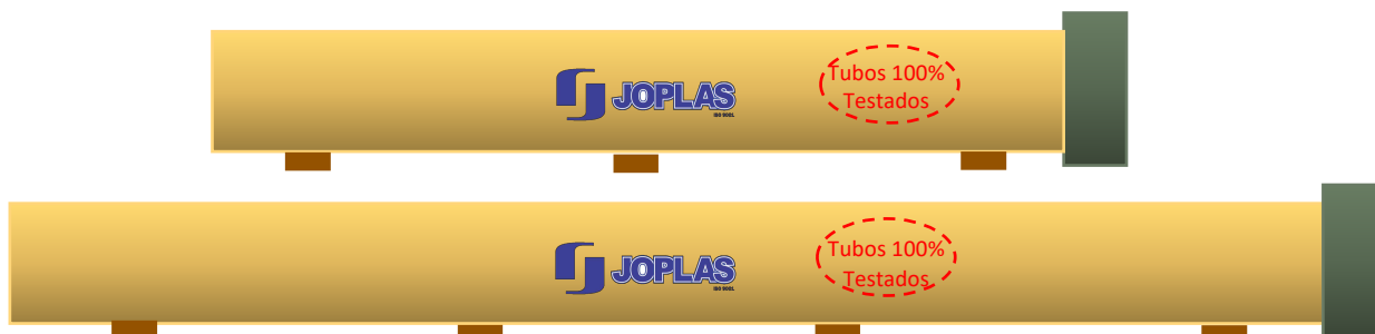
Figura 02 – Tubo 12 metros com 04 calços de madeira.
