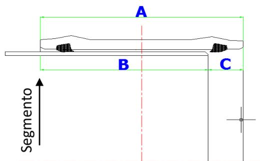
Fig. 10 luva posicionado sobre o segmento do tubo
