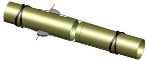
C – Por meio catracas em paralelo (tubos com diâmetro acima de 1.200mm).
