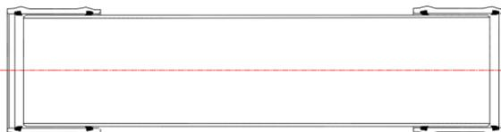
Fig. 11 segmento de tubo com as luvas de correr nas extremidades
