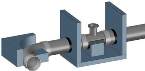
Os blocos de fixação jamais deverão estrangular a secção do tubo, mas também terão que ser moldados de maneira tal que não permita ao tubo deformar-se sob o peso do terreno. Além disso, entre o tubo e o concreto será colocada uma braçadeira de borracha envolvendo toda seção do tubo.
