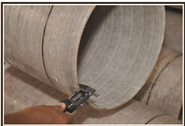
Verificação da espessura da parede do tubo.
