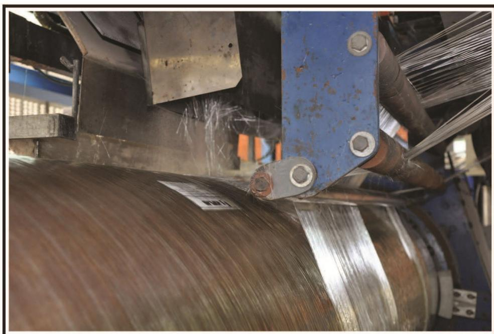
Fabricação dos tubos JOPLAS, através do processo de filamento contínuo.
